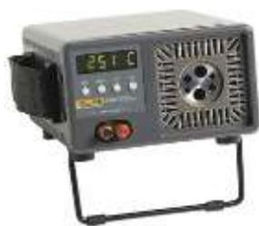
Температурный диапазон модели 9140 составляет  $35 - 350\text{ }^{\circ}\text{C}$ , при этом максимальная температура достигается за 12 минут. При весе менее 3 кг устройство имеет размер, достаточно малый для переноса в одной руке. Данная модель является настоящим новшеством среди сухоблочных калибраторов.
