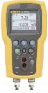
Назначение прецизионного калибратора давления Fluke 721:
