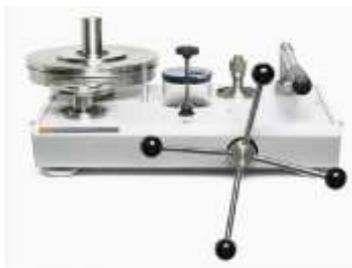
Модели P3200 выпускаются с одним или двумя поршнями для увеличения рабочих диапазонов. В качестве единиц измерения могут использоваться МПа, фунты/кв. дюйм, бар, кгс/см<sup>2</sup>. Эти надежные приборы демонстрируют высокую точность, скорость и простоту использования. Устройства отличаются встроенным заливным насосом для систем большого расхода, индикаторами хода поршней и высококачественным винтовым прессом для точного контроля давления.
