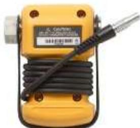
Описание вакуумного модуля давления FLUKE-750PV:
