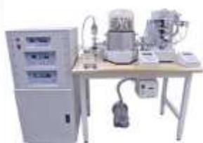
ADCS-601 – это полностью автоматизированный калибровочный стандарт летных данных эталонного класса для проверки и калибровки инструментов отслеживания, а именно приборов контроля летных данных (ADTS). Главная функция ADTS-601 заключается в калибровке статического давления барометрических датчиков в диапазонах Pt и Ps с очень низкой погрешностью измерений. ADCS-601 не предназначен для дублирования функций ADCS по калибровке и тестированию бортового оборудования воздушного судна.
