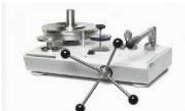
С целью расширения рабочего диапазона грузопоршневой манометр P3100 выпускается в вариантах с одним или двумя поршнями. В качестве единиц измерения могут использоваться МПа, фунты/кв. дюйм, бар, кгс/см<sup>2</sup>. Эти надежные приборы демонстрируют высокую точность, скорость и простоту использования. Устройства отличаются встроенным заливным насосом для систем большого расхода, индикаторами хода поршней и высококачественным винтовым прессом для точного контроля давления.
