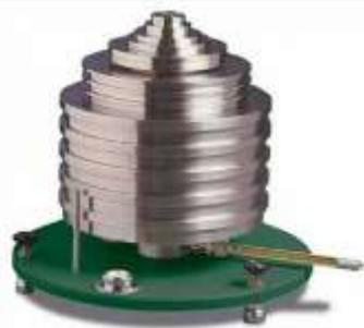
Газовый грузопоршневой манометр модели 2470 Gas Piston Gauge способен создавать манометрическое давление от 1,4 кПа до 20,7 МПа с точностью 0,0010 % от показаний в диапазоне до 690 кПа и 0,0025 % от показаний в диапазоне до 20,7 МПа.
