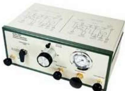
Блок ручного контроля давления серии 3990 служит удобным средством ручной регулировки давления как для тестируемого устройства, так и для калибровочного стандарта, такого как газопоршневой манометр или цифровой барометр.
